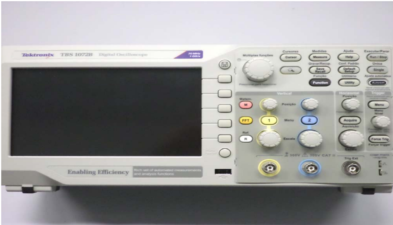
FIGURA 1 - Osciloscópio Digital, 70 MHz, amostragem 1GS/s, modelo TBS1072 B, marca TEKTRONIX
